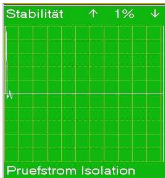
Die X-Achse des Oszilloskops hat eine automatische, variable Ablenkung die von der parametrisierten Prüfzeit direkt abhängig ist.
