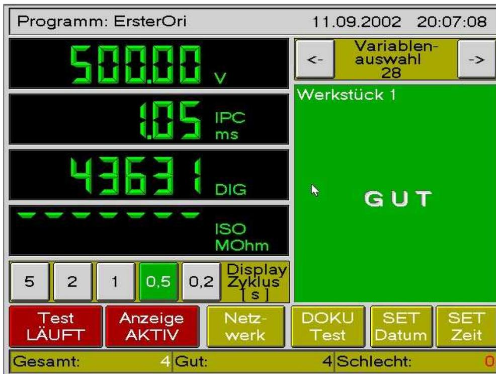
Wenn mit Parallelprüfung zweier Werkstücke gearbeitet wird und insgesamt ein Schlechtbefund erfolgt, wird die Prüfung automatisch für jedes Werkstück einzeln wiederholt, um das schlechte Werkstück selektieren zu können.
