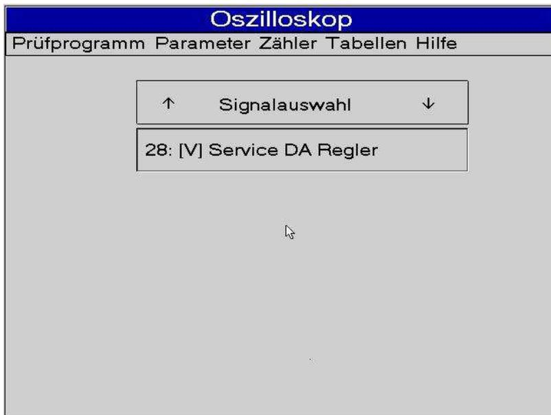
Durch direkte Berührung der Cursorsen Up/Down wählen Sie das Sie interessierende Signal (= Systemvariable)
